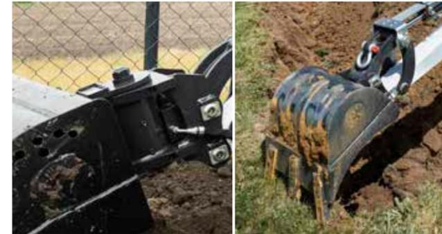
Mechanische Kupplung nach deutscher Bauweise (MS01) mit Kippfunktion
